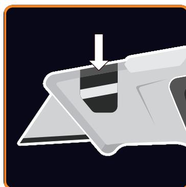
5. Закройте механизм блокировки до характерного щелчка.
